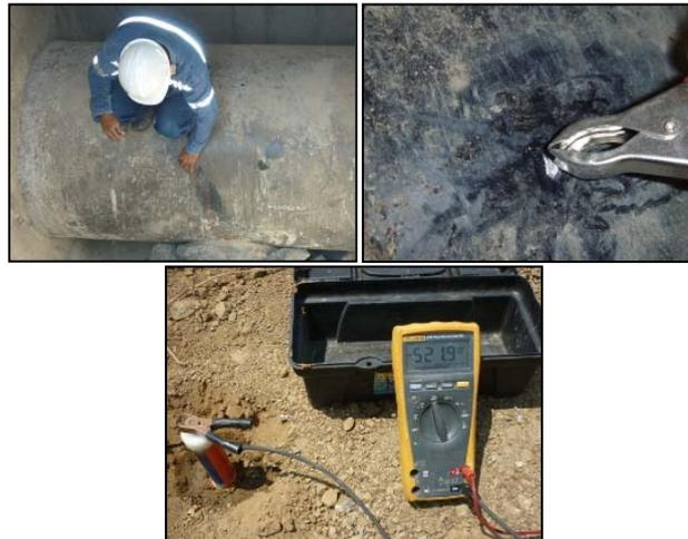
**FIG. 3.5. MEDICIÓN DE POTENCIALES ELÉCTRICOS**
