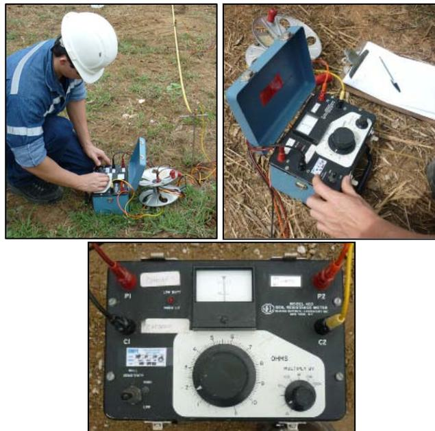
**FIG. 2.1. MEDICIÓN DE RESISTIVDADES ELÉCTRICAS
