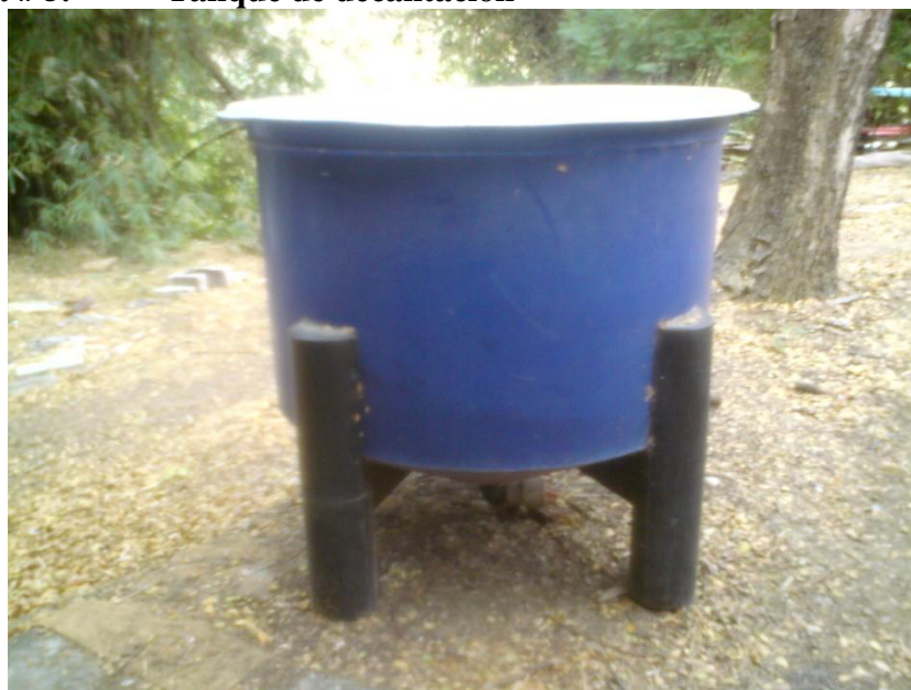
Figura # 5. Tanque de decantación
