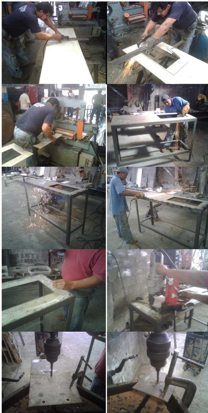
**FIG. 2.11 PROCESO DE CONSTRUCCIÓN DE LASPLACAS**
