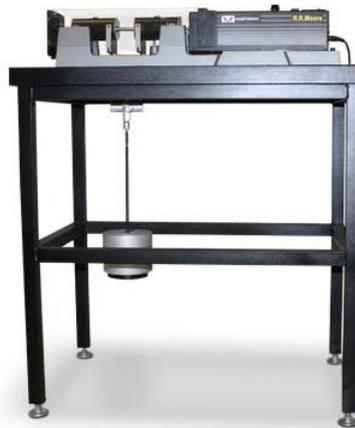
**FIG. 1.11 FOTOGRAFÍA DEL DISPOSITIVO DE FATIGA DE R.R. MOORE [20]**
