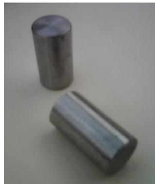
**FIG. 3.2 FOTOGRAFÍA DE LA PROBETA PARA ENSAYO DE DUREZA**
