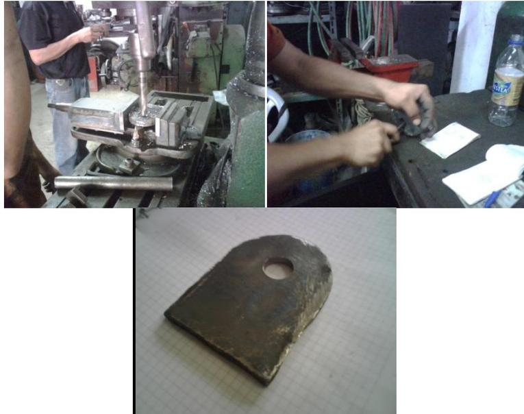
**FIG. 2.16 PROCESO DE CONSTRUCCIÓN DE LAS PLACAS
