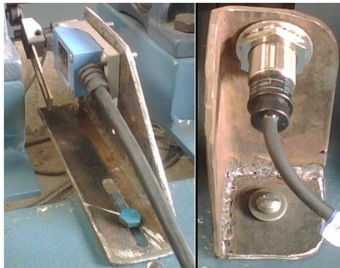
**FIG. 2.21 FOTOGRAFÍA DE LOS SOPORTES TERMINADOS**
