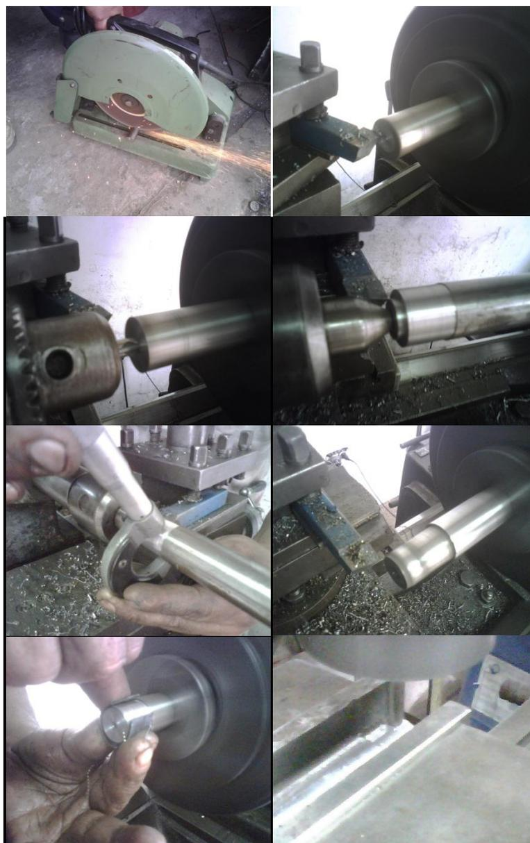
**FIG. 2.3 PROCESO DE CONSTRUCCIÓN DE LOS EJES**
