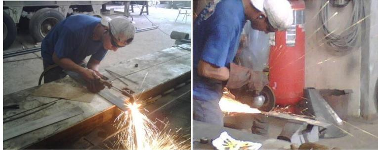
**FIG. 2.17 PROCESO DE CONSTRUCCIÓN DE PLATINA DE SOPORTE**
