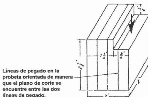
**GRÁFICO 2.12. *Probeta de Ensayo de Cortante***
