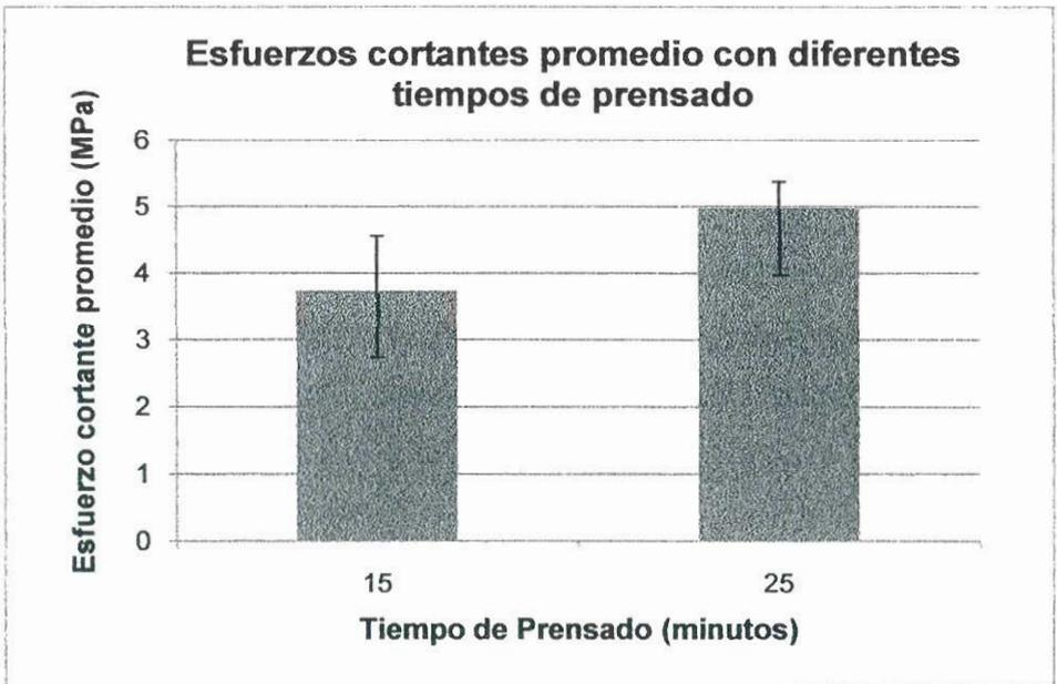
**GRÁFICO 4.22. Comparación de esfuerzos cortantes de probetas con diferentes tiempos de prensado**
