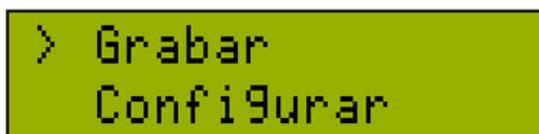
**Figura 2: Pantalla para Seleccionar Grabar o Configurar**
