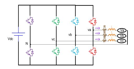
Figura 3. 26 Inversor conectado a la Red
