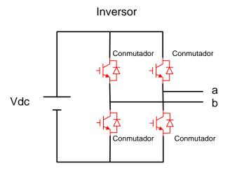
Figura 2. 20 Convertidor DC-AC Básico
