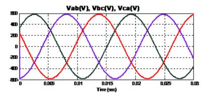
Figura 3. 12 Voltajes de línea a línea en el Inversor
