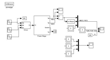
Figura 2. 24 Modelo del convertidor trifásico
