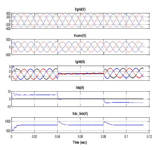
Figura 4. 8 Gráficas de la Corriente y Voltaje en el Inversor debido a cambios en el SMES
