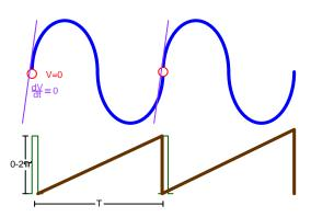
Figura 3. 24 Generación del ángulo de fase mediante cruce por ceros (PLL)
