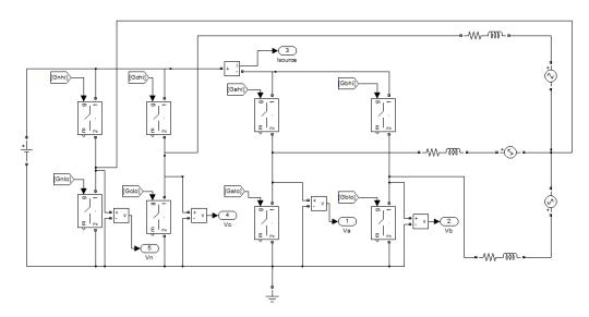
Figura 2. 25 Diagrama de Fuerza del convertidor trifásico
