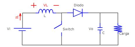
Figura 2. 9 Circuito del Boost con el Interruptor abierto
