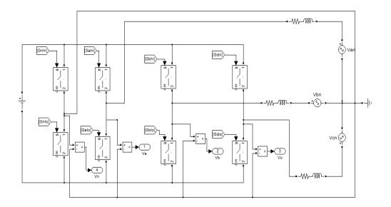
Figura 3. 10 Diagrama de Fuerza del Inversor Trifásico.
