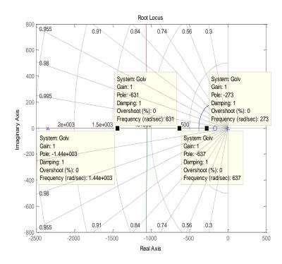
Figura 3. 34 Trayectoria de las Raíces de Lazo cerrado del controlador de voltaje del Inversor
