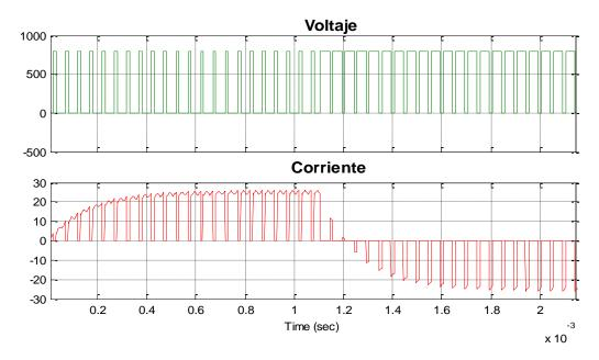
Figura 3. 9 Voltaje y Corriente de los Conmutadores del SMES
