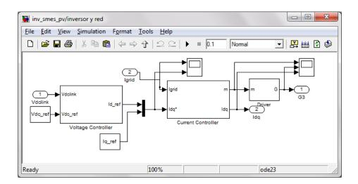
Figura 3. 30 Esquemático del Controlador para el Inversor
