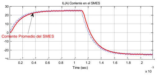
Figura 3. 8 Corriente en el inductor del SMES
