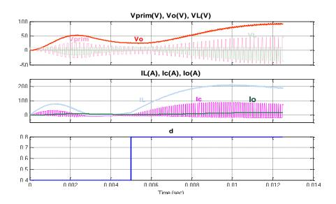
Figura 2. 19 Señales de Salida del Boost no Aislado
