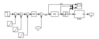
Figura 3. 14 Esquemático del Controlador del SMES
