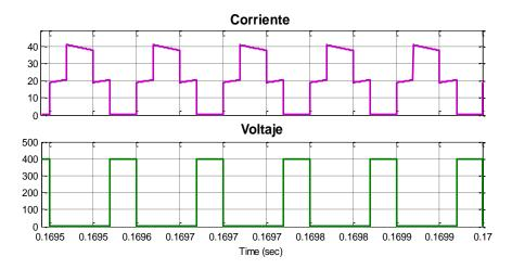
Figura 3. 6 Voltaje y Corriente de los Conmutadores
