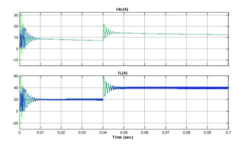
Figura 3. 21 Gráficas de Corriente del boost del PV
