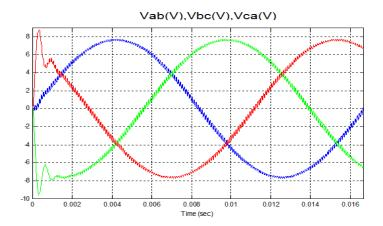
Figura 2. 27 Señales de voltaje
