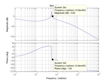
Figura 3. 19 Diagrama de Bode del Controlador para el Boost Aislado
