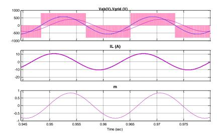
Figura 2. 26 Señales de salida del inversor trifásico
