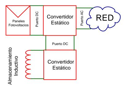
Figura 1. 7 PV conectado a red con almacenamiento
