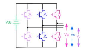
Figura 2. 22 Estructura del inversor 3Φ sin neutro
