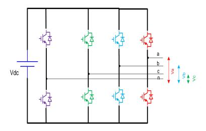
Figura 2. 23 Estructura del inversor 3Φ con neutro
