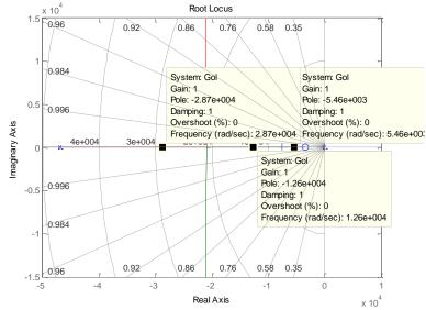
Figura 3. 16 Trayectoria de las Raíces de Lazo cerrado del Controlador para el Aislamiento
