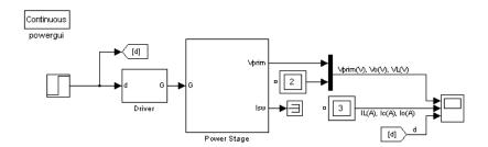
Figura 2. 17 Modelo del Boost dc-dc Aislado
