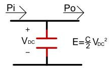
Figura 3. 29 Potencia del Dc\_link
