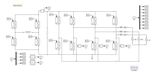
Figura 4. 6 Diagrama de fuerza del Inversor con el SMES
