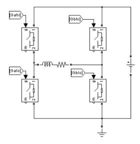
Figura 3. 7 Diagrama de fuerza del Boost no Aislado para Almacenamiento
