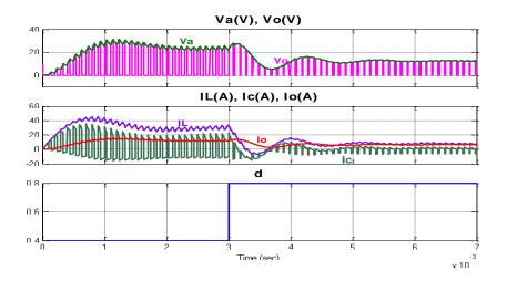
Figura 2. 15 Respuesta de las señales de salida del boost dc-dc
