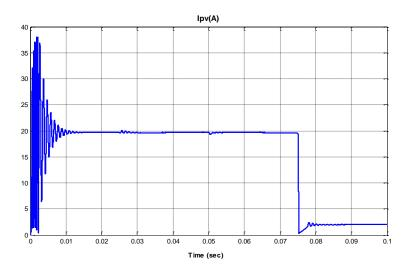
Figura 4. 14 Corriente en el PV
