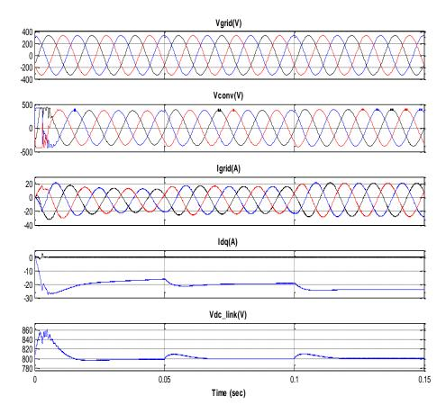
Figura 4. 12 Corrientes y Voltajes en el Inversor debido a cambios en el SMES y PV constante
