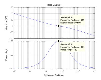
Figura 3. 32 Bode de la Ganancia de lazo abierto del controlador de voltaje del inversor
