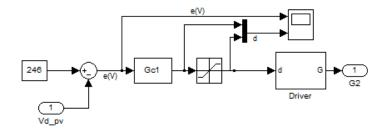
Figura 3. 18 Esquemático del controlador del Boost del PV
