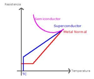
Figura 2. 28 Gráfico de Resistencia Vs. Temperatura
