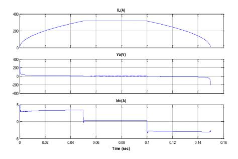
Figura 4. 11 Corrientes y Voltaje en el SMES
