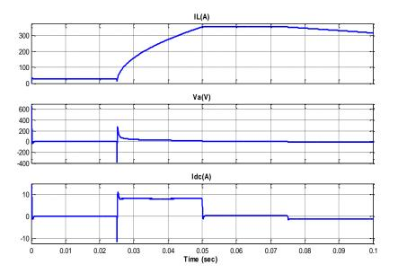
Figura 4. 13 Corriente y Voltaje en el SMES
