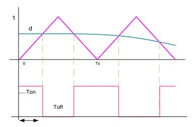
Figura 2. 21 Moduladora y portadora en un convertidor DC-AC
