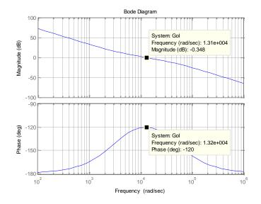
Figura 3. 15 Diagrama de Bode del Controlador para el Almacenamiento
