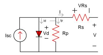
Figura 2. 2 Modelo del Panel fotovoltaico
