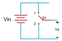
Figura 2. 6 Convertidor DC-AC básico
