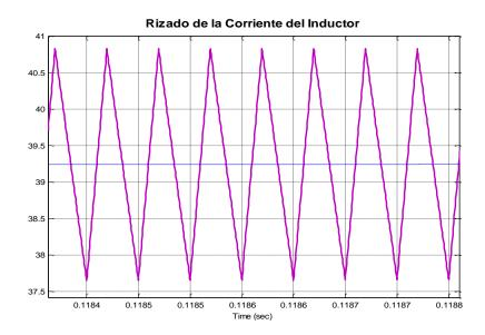
Figura 3. 2 Rizado de la Corriente del Inductor
