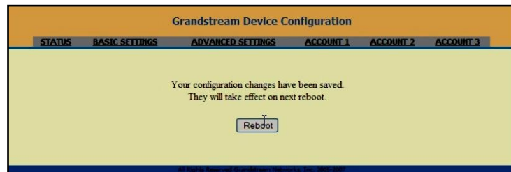
Figura 45 Reiniciando teléfono IP Grandstream
