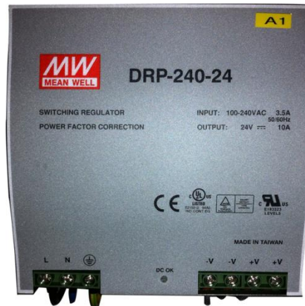
Figura 2.16 Fuente de voltaje de 24 Vdc.
