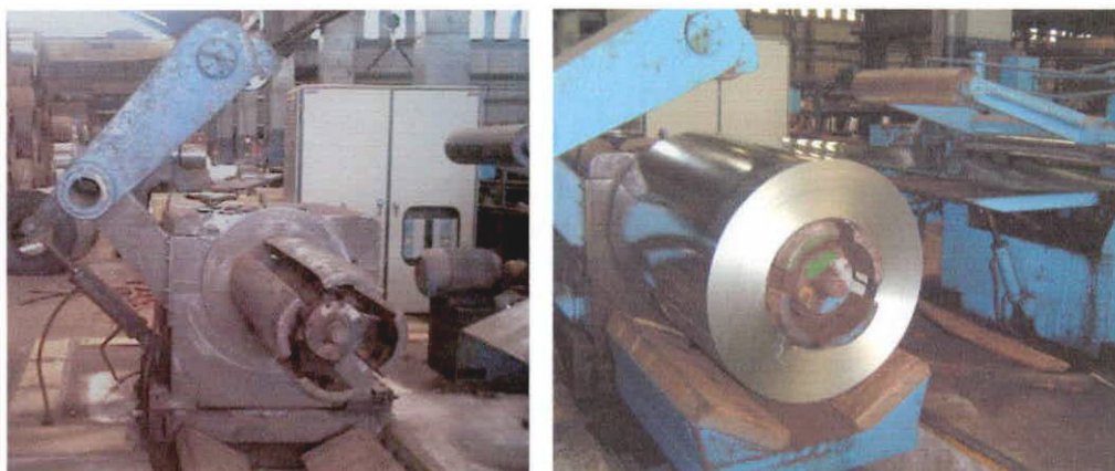
FIGURA 3.3 COLOCACIÓN DE BOBINAS SOBRE EL DESENROLLADOR
