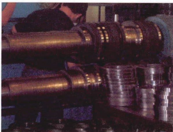
FIGURA 3.11 COLOCACION DE CUCHILLAS CIRCULARES
