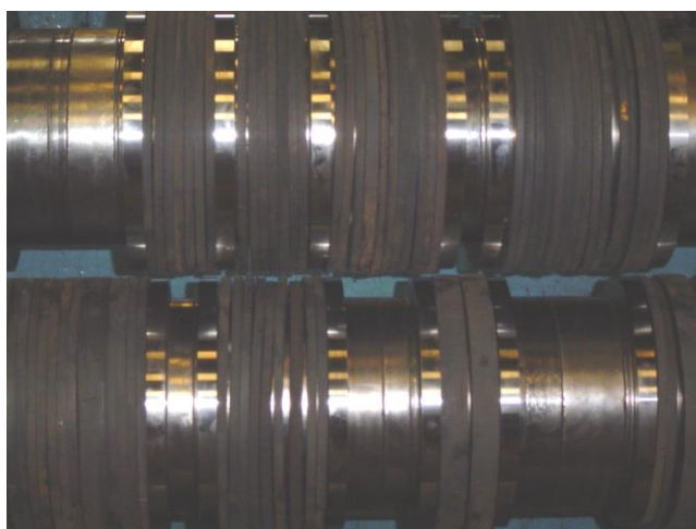
FIGURA 3.14 CUCHILLAS CIRCULARES CALIBRADAS
