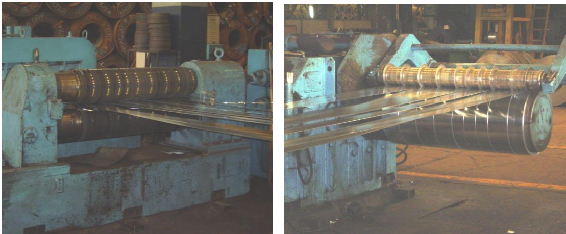
FIGURA 3.5 CORTE DE BOBINA / PRODUCCIÓN DE FLEJES
