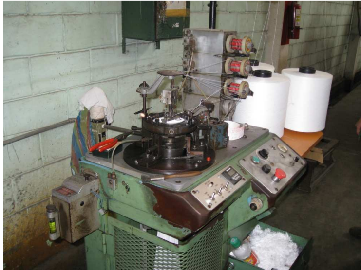
FIG. 1.2 MÁQUINA DE PRUEBA DE HILO FAK
