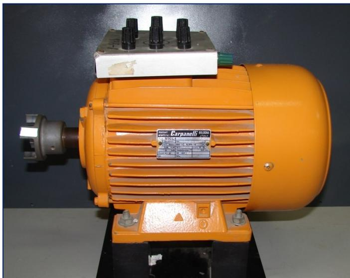
Figura 2.6.- Motor de inducción Terco-MV1009
