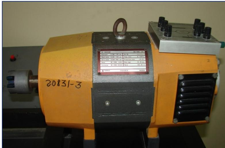
Figura 2.5.- Maquina de Corriente Continua Terco-MV1006
