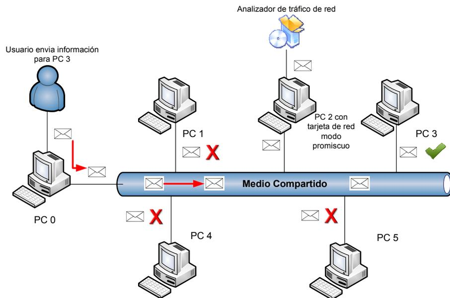
**Figura 2.2** Funcionamiento general de un analizador de redes
