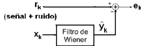
fig 3.9 diagrama del filtro de wiener
