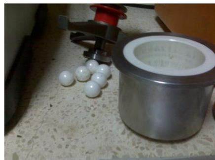
Foto 3.6 y 3.7 Molino Planetario, vaso y esferas
