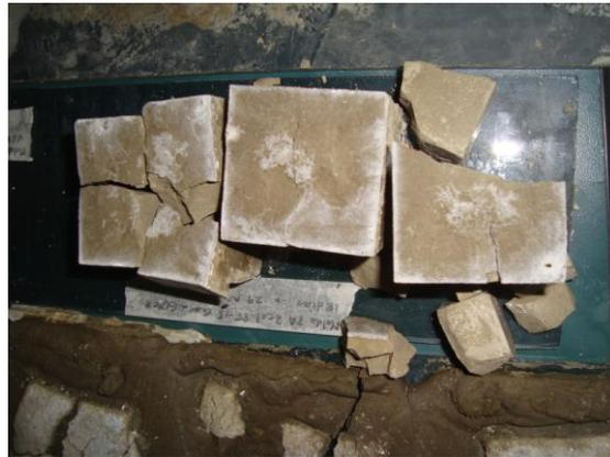
Foto 4.3 Mortero de Z1\_85%\_80C\_28 D después de curado
