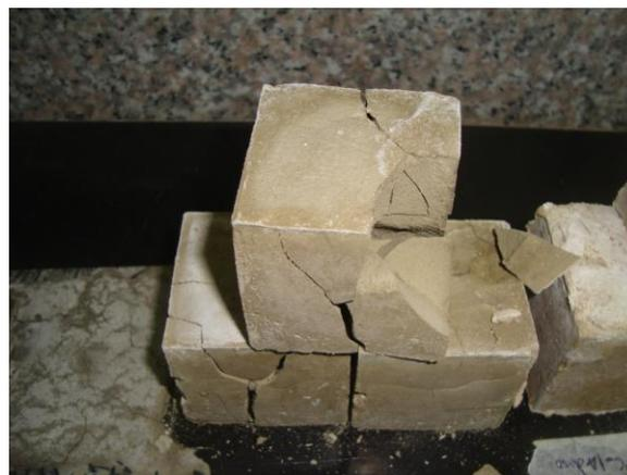
Foto 4.4 Mortero de Z1\_85%\_80C\_14D después de curado
