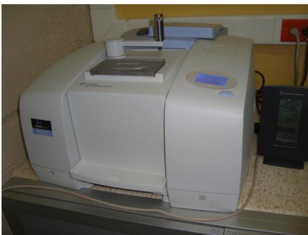
Foto 3.13 Espectrómetro FTIR
