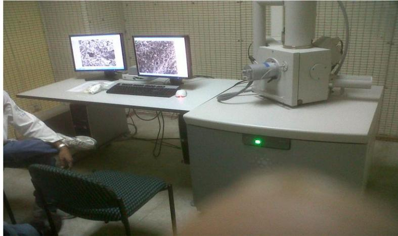
Foto 3.12 Microscópio electrónico de barrido
