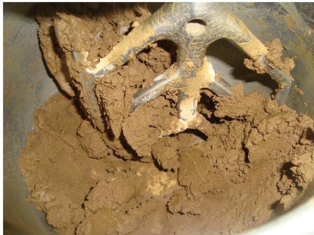
Figura 3.9 Zeolita activada durante mezcla
