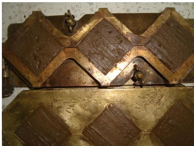
Foto 3.10 Moldes de morteros de zeolita
