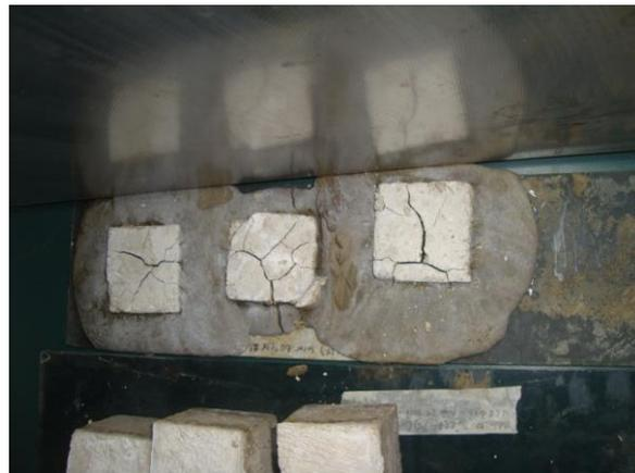
Foto 4.2 Mortero de Z1\_75%\_80C\_28d después del curado
