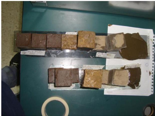
Foto 4.1 Cubos de Morteros después del desmolde
