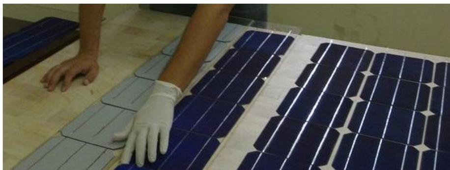
**FIGURA 7.23 DISTRIBUCIÓN DE LAS FILAS DE CELDAS FOTOVOLTAICAS**
