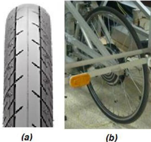
**FIGURA 7.14 RUEDA POSTERIOR (A) LLANTA (B) RUEDA ARMADA**
