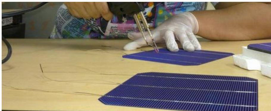
**FIGURA 7.21 PROCESO DE SOLDADO DE LAS CELDAS FOTOVOLTAICAS.**
