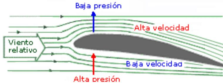
**FIGURA 2.2 COMPORTAMIENTO DEL FLUJO EN EL ALA DE UN AVIÓN**
