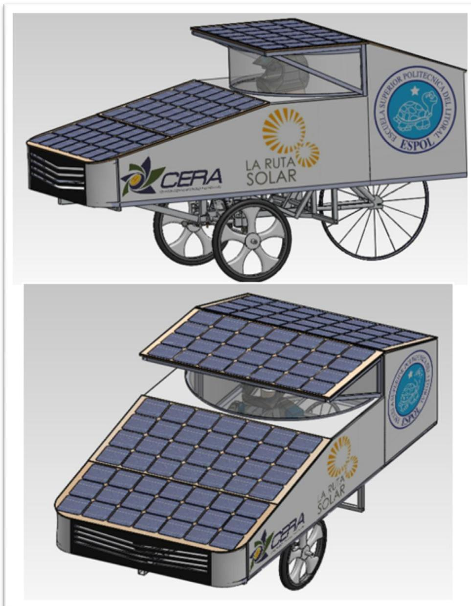
**FIGURA 3.18 PERSPECTIVAS DEL DISEÑO FINAL DE LA CARROCERÍA**
