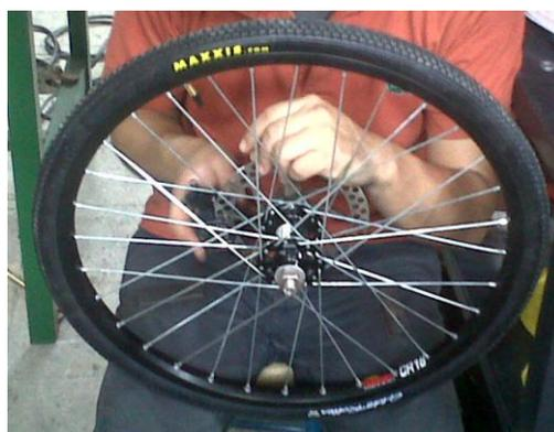
**FIGURA 7.13 RUEDA DELANTERA ARMADA**
