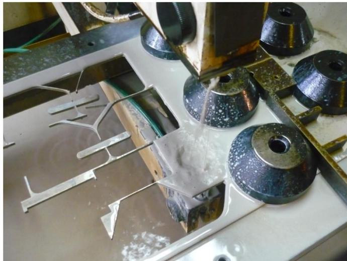
**FIGURA 7.2 MÁQUINA CORTADORA DE HILO**
