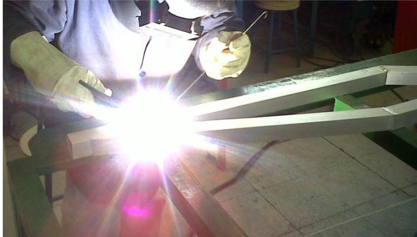
**FIGURA 7.5 SOLDADURA TIG DEL ALUMINIO**
