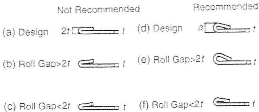
Fig. 2.5 Diseños para doblado a 180° [6].
