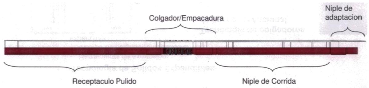
**Figura 5.3 Componentes del Sistema**
