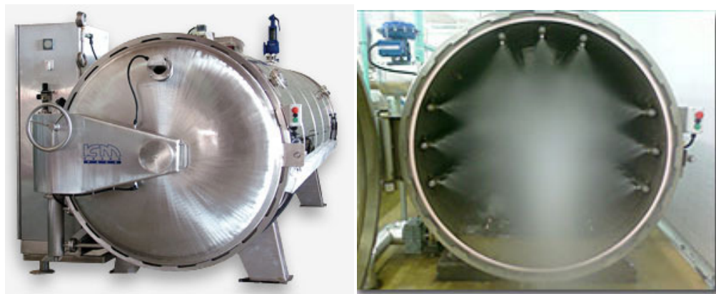
Fig. 2.13: Autoclave modelo KM Grand pack por espray de agua con sobrepresión
