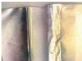
Fig. 2.10 Criterio de observación visual en la prueba de tensión de sello
