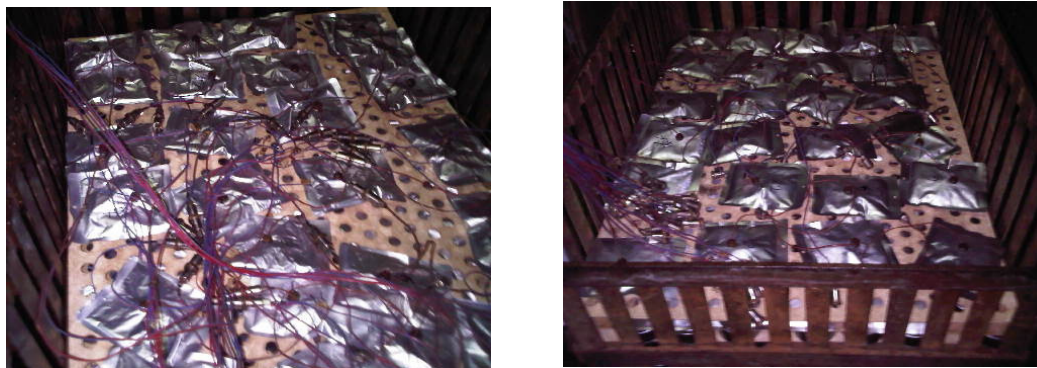
Fig. 3.9 Albacora en empaque flexible con termocuplas para proceso con vapor saturado
