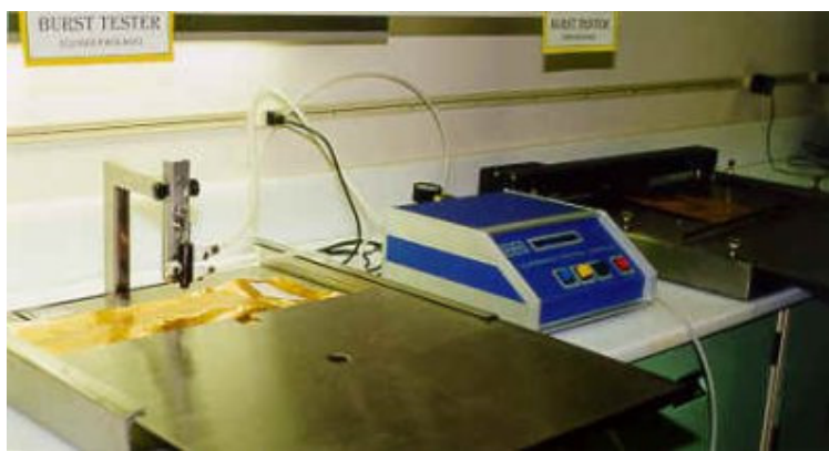
Fig. 2.6: Equipo para prueba de presión interna
