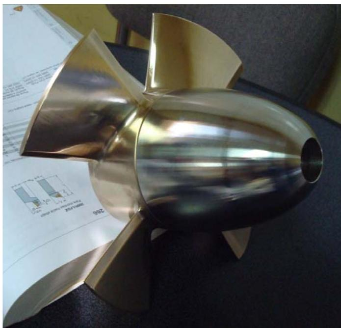
FIGURA 2.18 RODETE DE TURBINA AXIAL.
