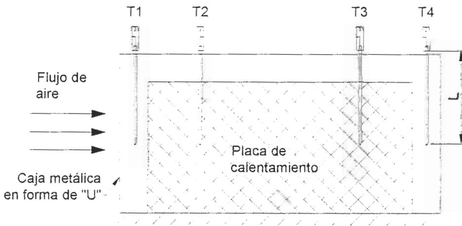
**FIGURA 2-35 DISTRIBUCION DE TERMOPARES EN EL EQUIPO DE CONVECCION.**
