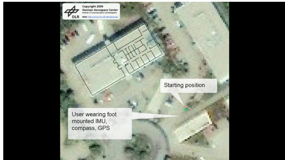
Figura 2. Multi-sensor pedestrian indoor / outdoor navigation (demostración)
