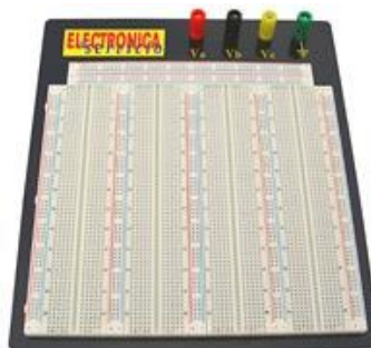
Figura 3.1.: Protoboard de 4 regletas.
