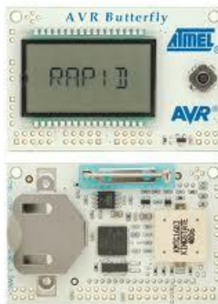
Figura 2.3.: Vistas frontal y posterior del AVR Butterfly
