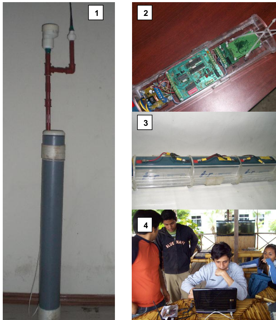
Figura 3. Sistema DMR. (1) Flotador DMR. Nótese el domo de GPS y la antena de radio colocado en el mástil de antenas. (2) Bahía de electrónicos, en el que se aprecia la tarjeta madre del DMR, su fuente reguladora, y el receiver del GPS. (3) Bahía de baterías, en la que constan tres baterías de 6V recargables dispuestas en serie, lo que le confieren al DMR una capacidad operativa de cerca de 84 horas. (4) Estación terrena, compuesta por una computadora laptop , el receiver de radio y su antena. La configuración mostrada en la foto pertenece a las pruebas realizadas en CENAIM antes de su despliegue operacional. En tareas normales de adquisición de datos, se dispone de una antena de alta ganancia que permite un mayor alcance.
