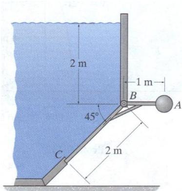
2.- Si la masa del contrapeso en A es de 6500 Kg, determine la fuerza que ejerce la compuerta sobre el tope liso en C. La puerta está articulada en B y tiene 1 metro de longitud. La densidad del fluido es de 900 Kg/m<sup>3</sup>. (25 %)
