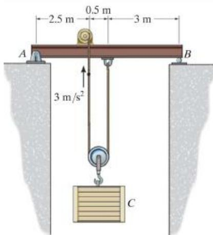
4.- Si el motor tira del cable con una aceleración 3 m/s<sup>2</sup>, determine las reacciones en los apoyos A y B. La viga tiene una masa uniforme de 30 Kg/m, y la caja tiene una masa de 200 Kg. Desprecie la masa de l motor y de las poleas. (25%)
