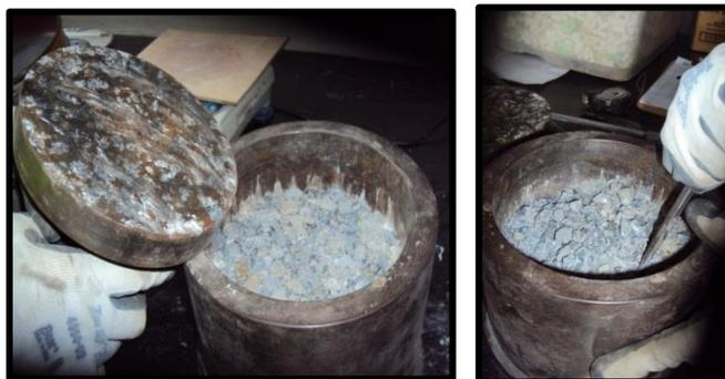
**Ilustración 3. 12 Agregados Triturados.**
