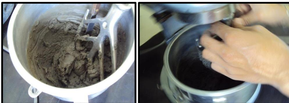
**Ilustración 5. 1 Mezclado de Mortero para Refrentar.**
