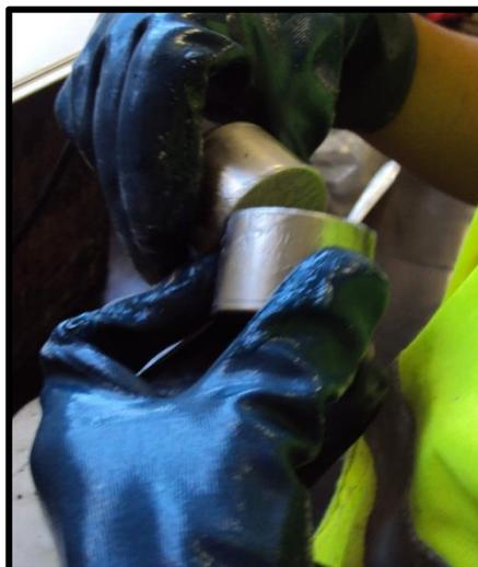
Ilustración 5. 9 Ensayo de Pulso Ultrasónico.
