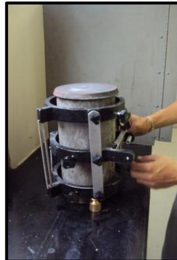
**Ilustración 5. 6 Extensómetros para Medir Deformación de Cilindros.**
