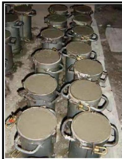
**Ilustración 9. 10 Cilindros de HCR para Realizar Pruebas.**
