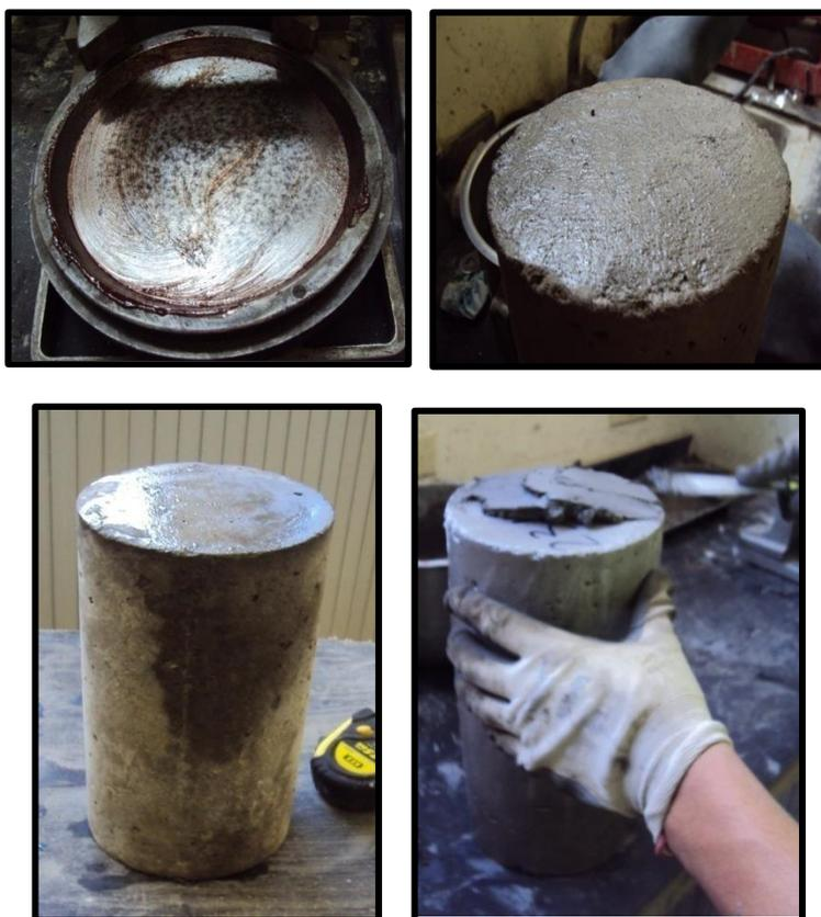
**Ilustración 5. 3 Colocación de Mortero a los Especímenes.**
