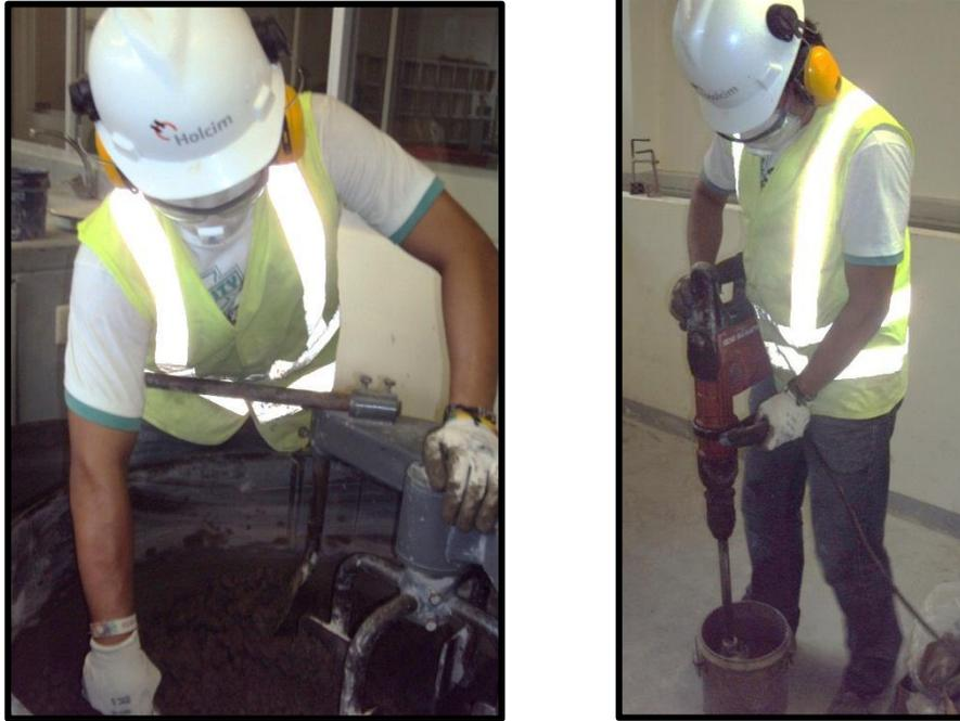
**Ilustración 4. 12 Mezclado y Compactación de Materiales.**
