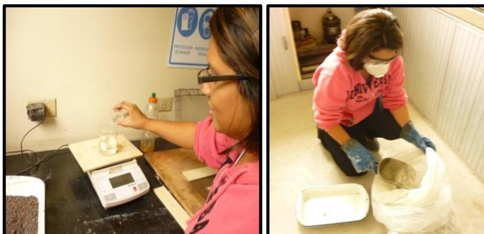
**Ilustración 4. 10 Pesado de Materiales para Elaboración de Mezcla.**
