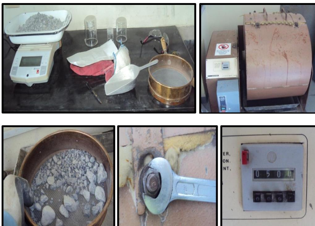
Ilustración 3. 23 Procedimiento para Ensayo de Abrasión.
