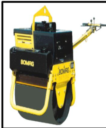
**Ilustración 8. 10 Compactador Simple - Monocilindrico, Tomado de [www.viarural.com.ec](http://www.viarural.com.ec).**
