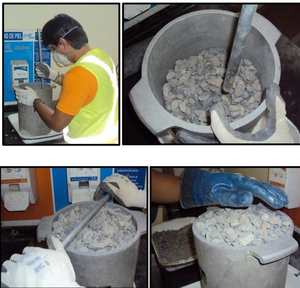
**Ilustración 3. 16 Procedimiento para Determinar Masa Unitaria-Agregados Gruesos.**
