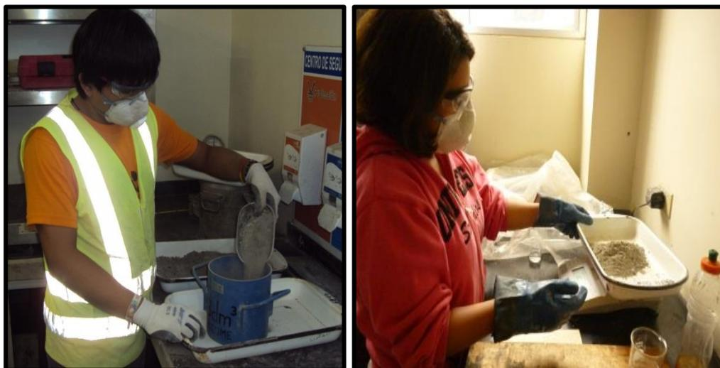
**Ilustración 3. 17 Procedimiento para Determinar Masa Unitaria-Arena.**
