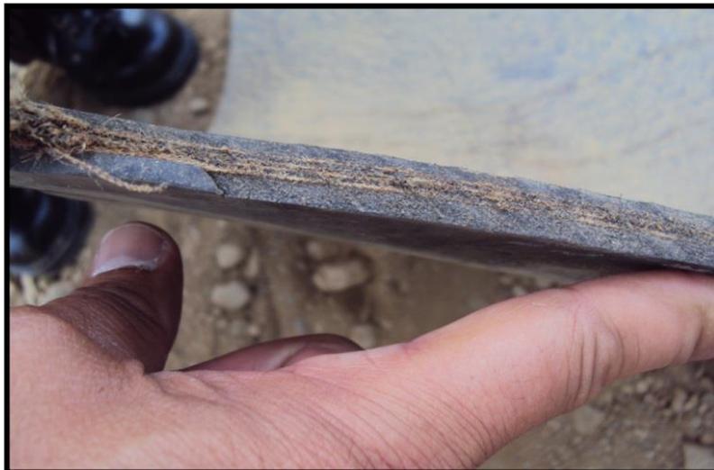
**Ilustración 7. 17 Sección Transversal de la Cinta Transportadora Planta Móvil HOLCIM.**
