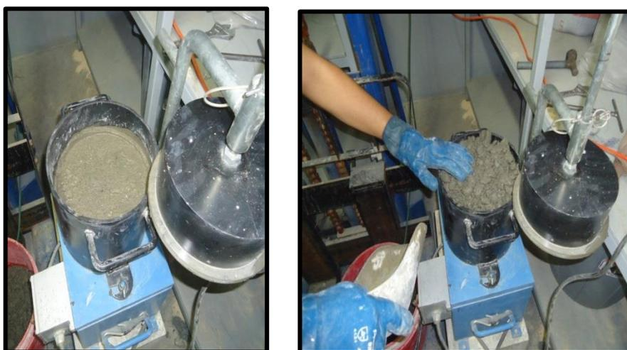
**Ilustración 4. 17 Ensayo Vebe, Determinación de Trabajabilidad.**
