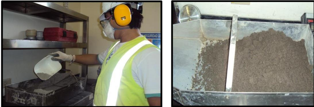
**Ilustración 4. 15 Pesando Arena para Diseño de HCR.**
