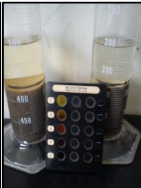
Ilustración 3. 19 Vertiendo Solución con Agua a la Arena.
