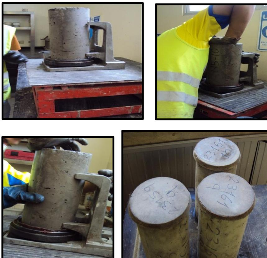
**Ilustración 5. 4 Proceso de Vibración y Acabado del Refrentado.**
