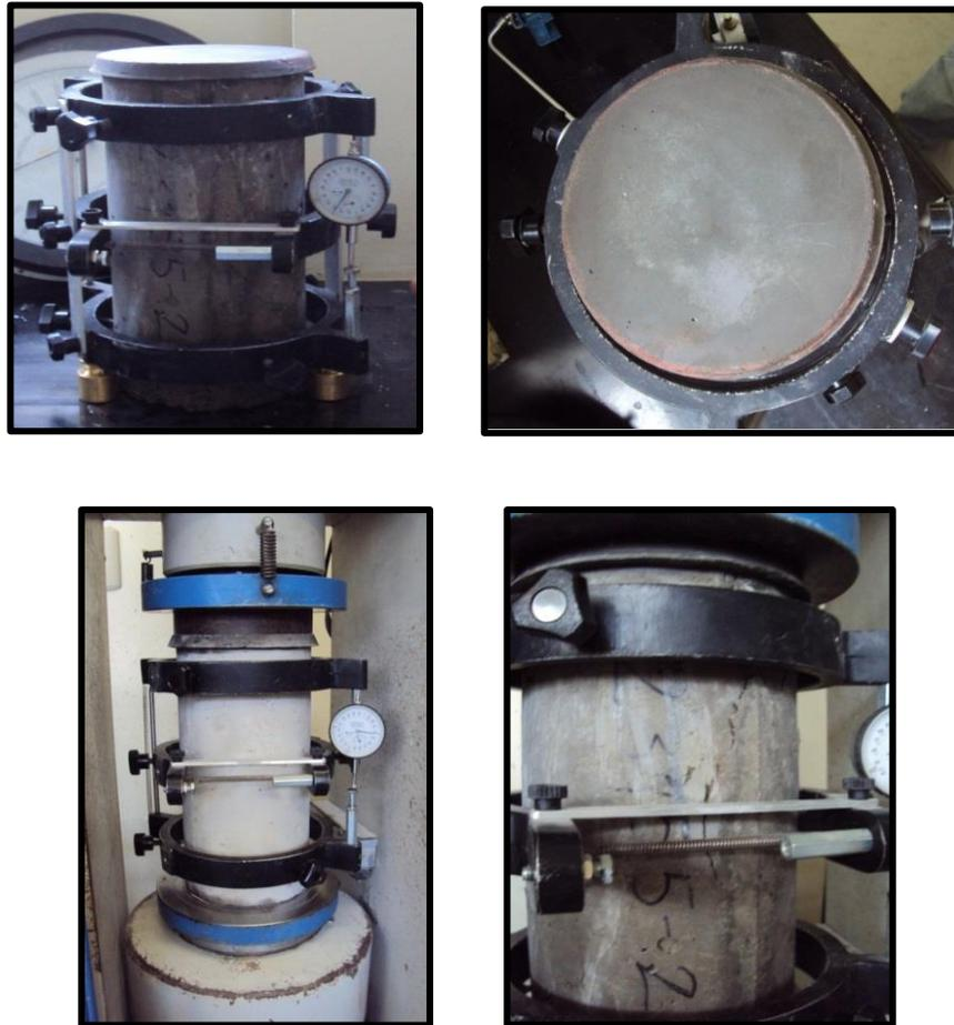
**Ilustración 5. 7 Determinación del Módulo de Elasticidad**
