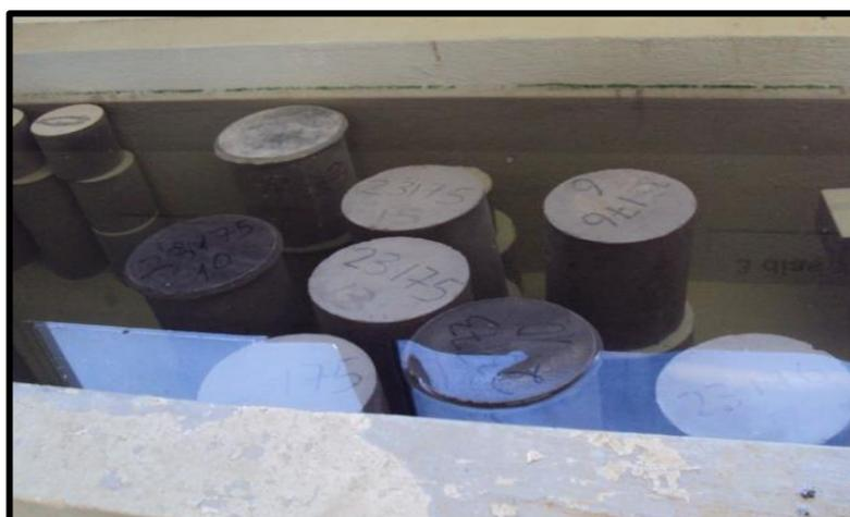
**Ilustración 4. 20 Curado de Especímenes.**
