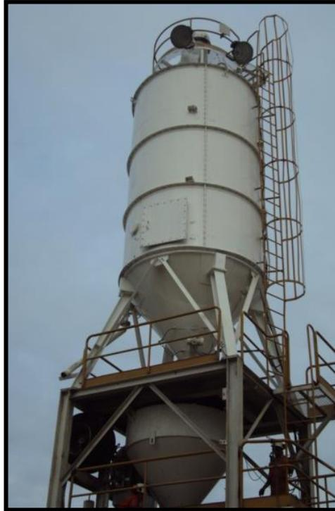
**Ilustración 7. 5 Silos de Almacenamiento de Cemento y en la parte Inferior Silos de Aditivos.**
