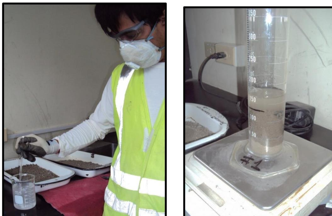
**Ilustración 3. 18 Preparación de Solución de Hidróxido de Sodio.**
