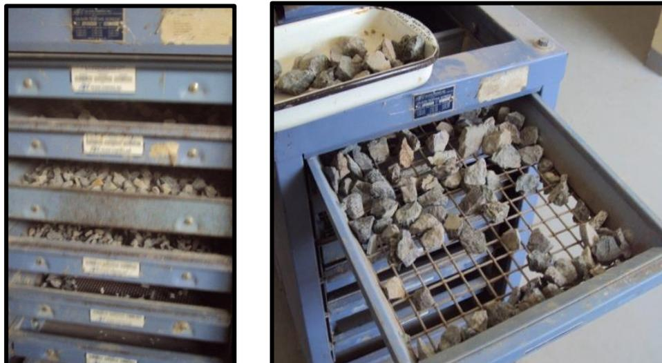
Ilustración 3. 7 Tamizadora para Agregado Grueso.
