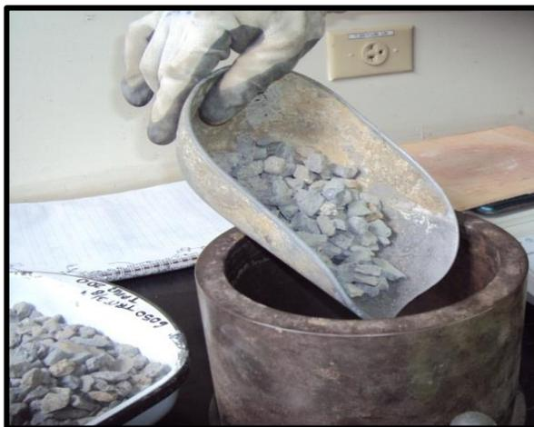
Ilustración 3. 10 Ensayo Valor de Trituración.
