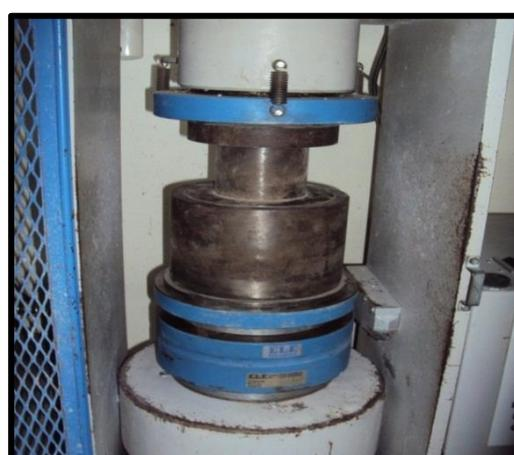
Ilustración 3. 11 Varillado y Colocación de Muestra en Presas.
