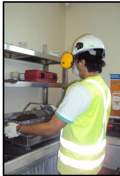
**Ilustración 4. 14 Pesando Piedra #4 para Diseño de HCR.**
