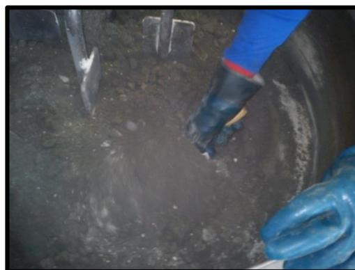
**Ilustración 5. 11 Elaboración Especímenes para Coeficiente de Dilatación Térmica.**
