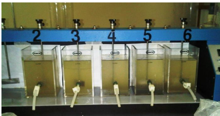
Figura 3. 8 Determinación pH óptimo, prueba de jarras #1 Fuente: Morales, A.
