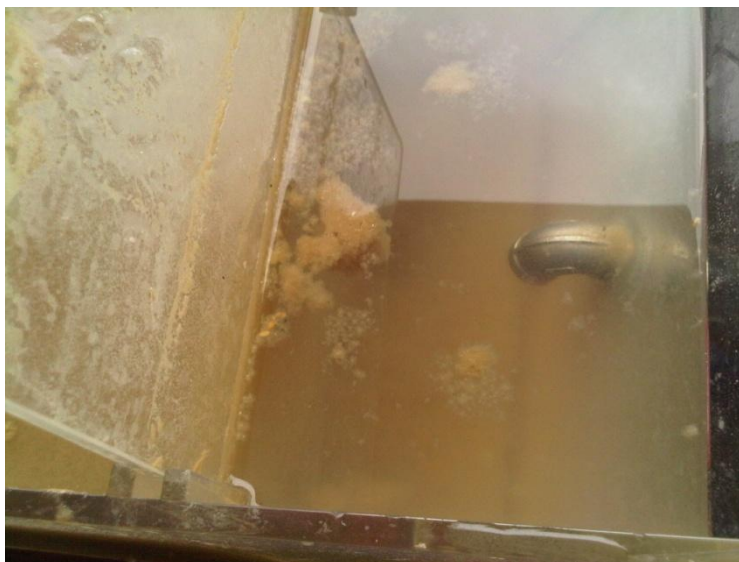
Figura 3. 2 Resuspensión de lodos, reactor continuo Fuente: Morales, A.
