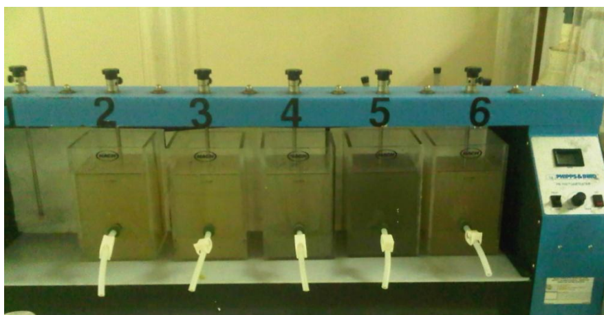
Figura 3. 7 Equipo utilizado, jar test Phipps & Bird PB 750 Fuente: Morales, A.
