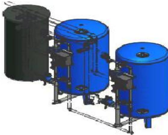
FIGURA 3.18 SISTEMA DE ABLANDAMIENTO DE AGUA
