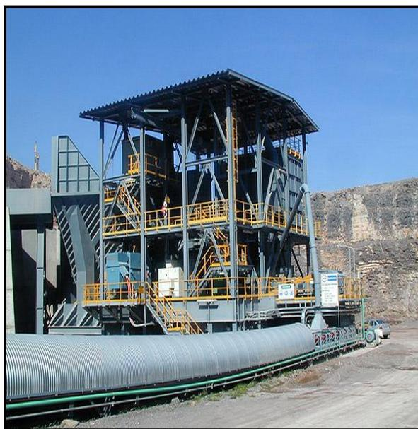
**Figura 1.12 Instalación Estacionaria de Trituración Primaria
