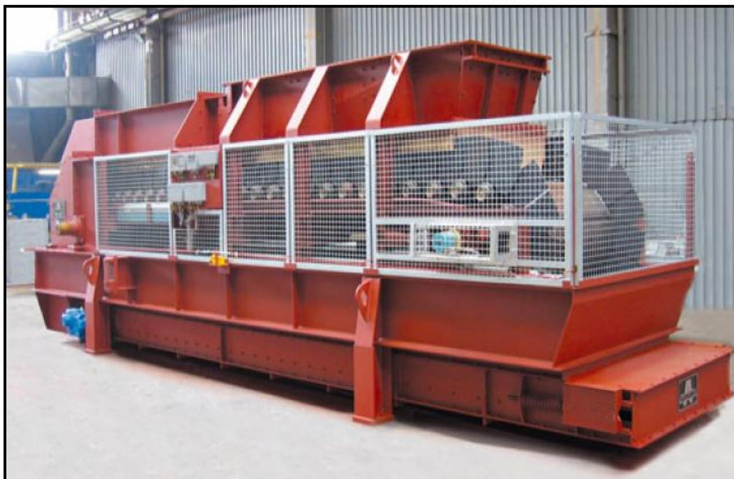
**Figura 2.41 Alimentador de Placas metálicas**
