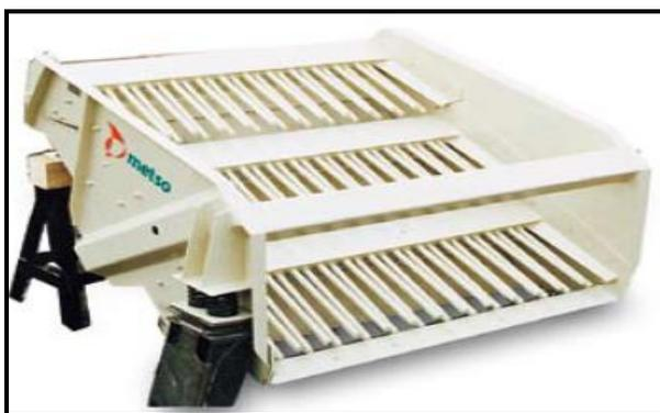
**Figura 2.56 Esquema del Alimentador Vibratorio**
