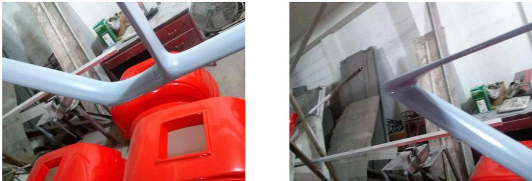
Figura 36: Acabado y Recubrimiento con Poliuretano
