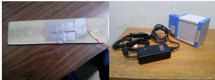
Figura 66 Extensómetro Instalado y Dispositivo para Adquisición de Datos.
