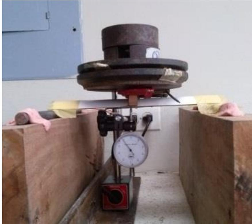
Figura 25: Prueba Experimental de Flexión
