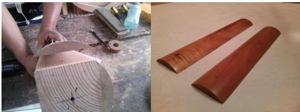
Figura 33: Construcción de los moldes machos de los Folios
