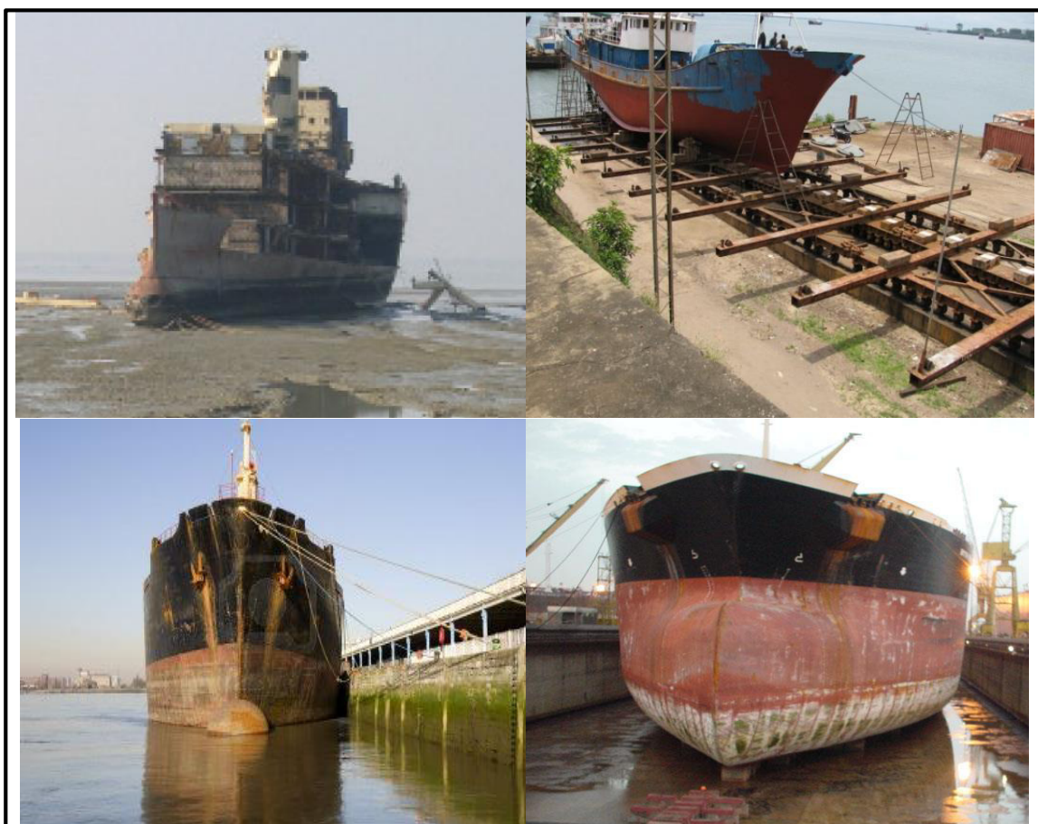
Figura 15: Formas de varada para el desguace, [12].
