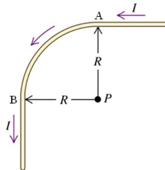
Podemos dividir el cable en tres secciones: dos segmentos rectos semi-infinitos y un cuarto de círculo. En la figura, los segmentos son como sigue: un alambre recto semi-infinito desde  $\infty$  hasta A, un cuarto de círculo de A a B, y un alambre recto semi-infinito de B a  $\infty$ . El centro del círculo está en un extremo de los segmentos semi-infinitos.
