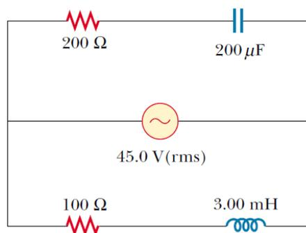
Cuando la frecuencia es muy grande, el ramal inferior lleva una corriente insignificante pues  $X_L = \omega L$  se comporta prácticamente como un circuito abierto.
