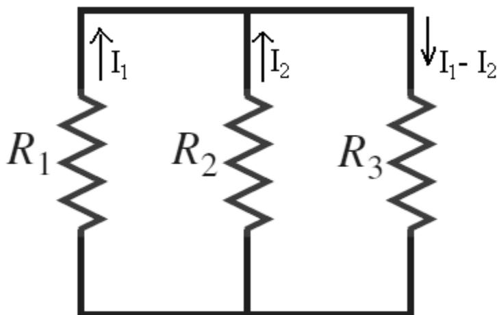
Etiquetando la corriente a través del resistor  $R_1$  como  $I_1$  hacia arriba y la corriente a través del resistor  $R_2$  como  $I_2$  hacia arriba. Entonces, la corriente a través del resistor  $R_3$  será  $I_1 + I_2$  hacia abajo. Tomando un camino en sentido horario en la malla izquierda tenemos:
