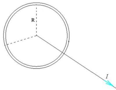
El campo magnético creado por el conductor es tangente a la superficie del anillo, por lo que no hay flujo magnético que atraviese la superficie encerrada por el anillo. Por lo tanto, no se induce ninguna corriente.
