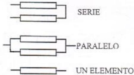
Indique la manera en que los elementos calefactores deben conectarse a una fuente de alimentación, como la de nuestros hogares, con el fin de proporcionar los tres ajustes.
