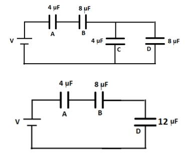
DE ESTOS TRES CAPACITORES (4, 8 Y 12) μF EN SERIE CON LA FUENTE, ALMACENA MAS ENERGÍA EL QUE TIENE MENOS CAPACITANCIA (EL DE 4μF). YA QUE TODOS ESTAN EN SERIE Y TIENEN LA MISMA CARGA.
