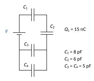
a) ¿Cuánta energía se almacena en el capacitor  $C_3$  cuando la red de capacitores es conectada?
