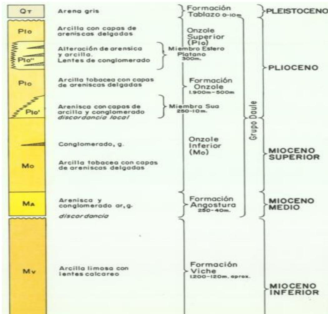
Columna Estratigráficas (a escala 1: 20.000) de las formaciones geológicas que atraviesa la tubería del poliducto desde el PK-00 (ciudad de Esmeraldas) hasta el PK-36 (Viche). Extracto de imagen de la hoja geológica Esmeraldas y Punta Galera a escala 1: 10000
