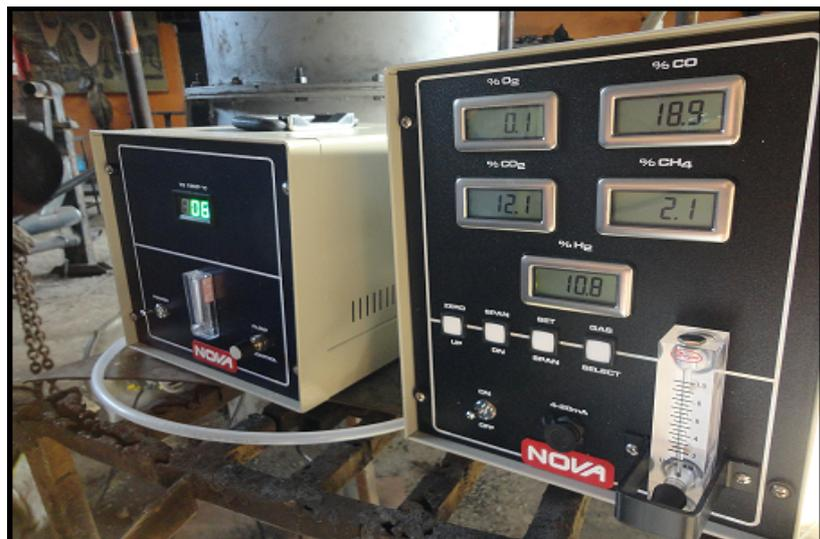
**FIGURA 3.3 ANALIZADOR DE GASES DURANTE LA OPERACIÓN DE TOMA DE MUESTRAS**
