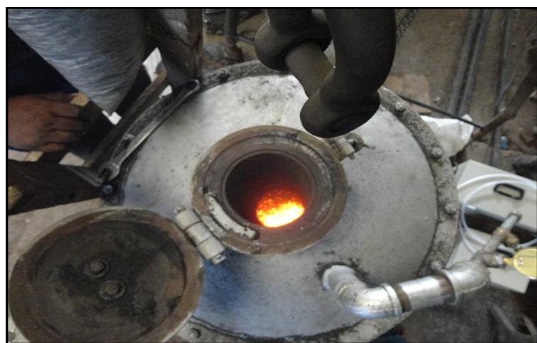
FIGURA 4.2 OPERACIÓN, CARGADO DEL MATERIAL, Y MONITOREO DEL GAS PRODUCTO
