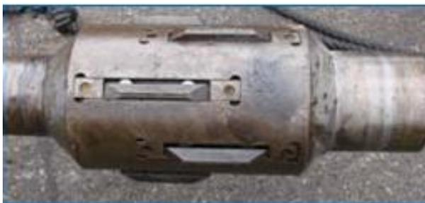
Figura 2.42 Ancla de Torsión (FUENTE: SERTECPET)
