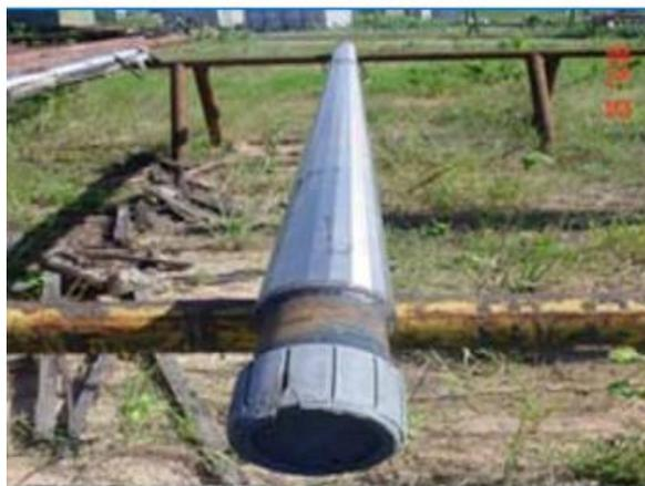
Figura 2.37 Estator (FUENTE: MISSION PETROLEUM)
