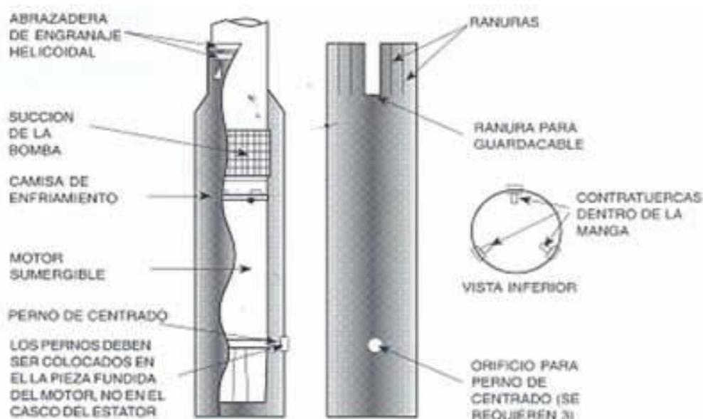
Figura 2.22 Camisa de Enfriamiento (si es necesario) ( FUENTE: Imagen tomada página web [http://www.jpk.com.ve/motores\\_sumergibles.htm](http://www.jpk.com.ve/motores_sumergibles.htm))
