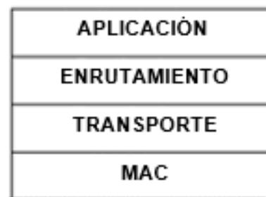
Figura 1. Capas del protocolo Z-Wave.
