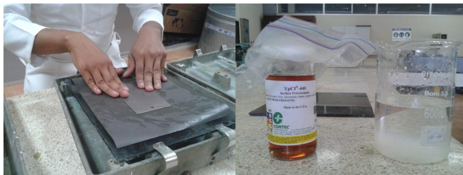
FIGURA 3.70. LIJADO DE PLACAS METÁLICAS NORMALIZADA
