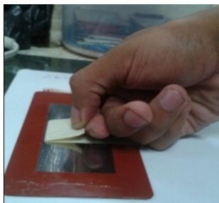
FIGURA 2.31. ENSAYO DE ADHERENCIA SOBRE PLACAS NORMALIZADAS
