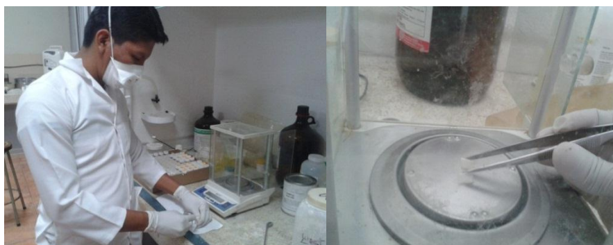
FIGURA 3.58. PESAJE DE PROBETA EN PRUEBA DE HINCHAMIENTO
