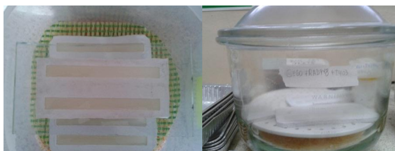
FIGURA 3.65. MEZCLA EN LOS MOLDES Y DESCANTES PARA CURADO
