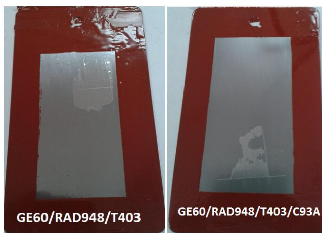
FIGURA 4.37. ADHERENCIA DE RESINAS (GE60, RAD948) - AMINA-ARCILLA
