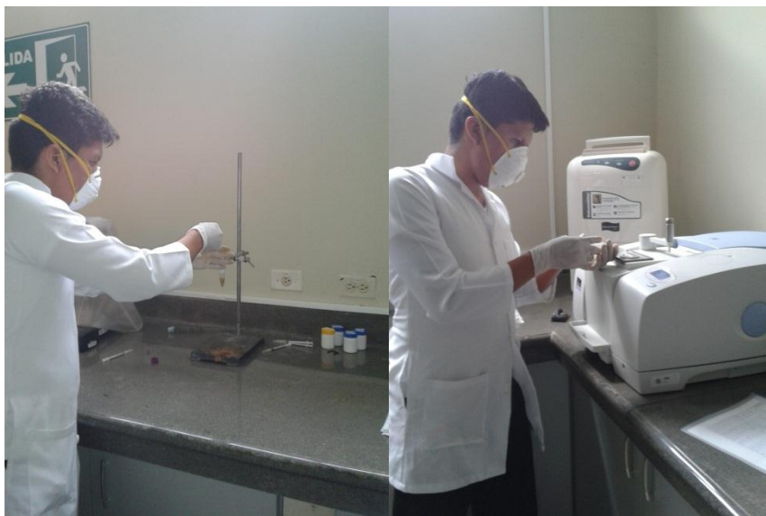
FIGURA 3.59. COLOCACIÓN DE MUESTRA EN EL TUBO DE ENSAYO Y FTIR
