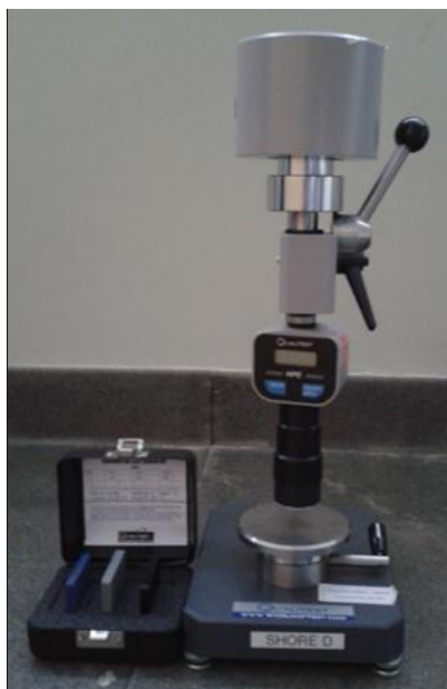
FIGURA 2.28. ENSAYO DE DUREZA (ASTM D2240-05)
