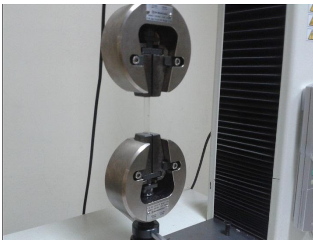
FIGURA 2.27. ENSAYO DE TENSIÓN (ASTM 882-12)
