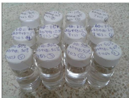
FIGURA 2.30. PRUEBA DE HINCHAMIENTO (ASTM D 570)
