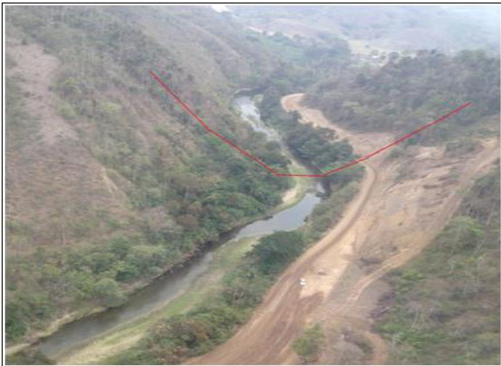
**Figura 3.2: Sitio de presa (cerrada C1), el eje está marcado aproximadamente, el vaso se ve al fondo.**
