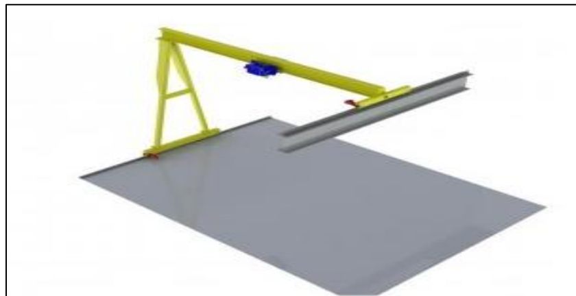
Figura 2.13 Grúa pórtico con una sola columna monorriel. [10]
