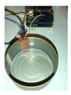
Figura 4.4 Evaporímetro.
