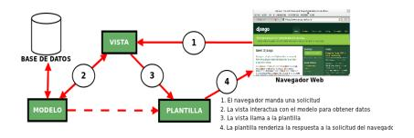
Figura 3.6 El patrón de diseño MVT.
