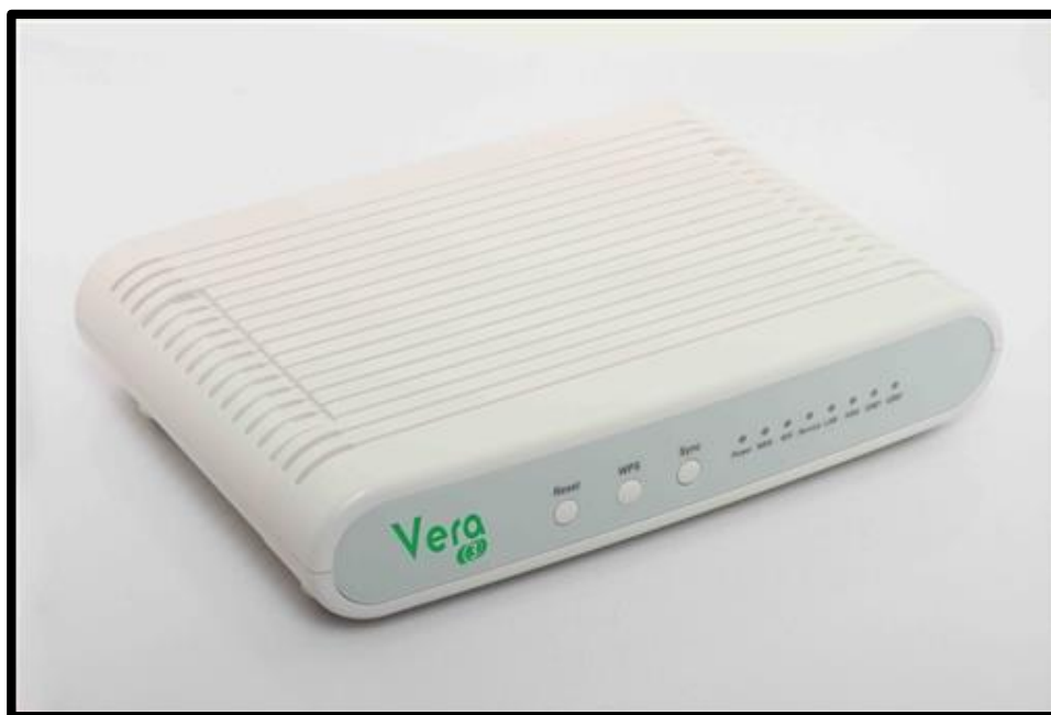
Figura 4.2: Dispositivo controlador del sistema domótico VERA3.
