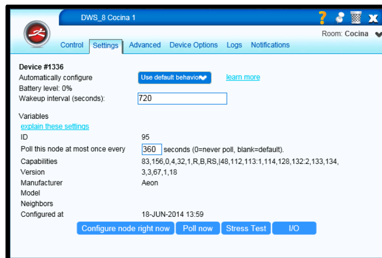
Figura 4.80: Pestaña de Settings del panel de configuración del sensor de apertura y cerrado de puertas.
