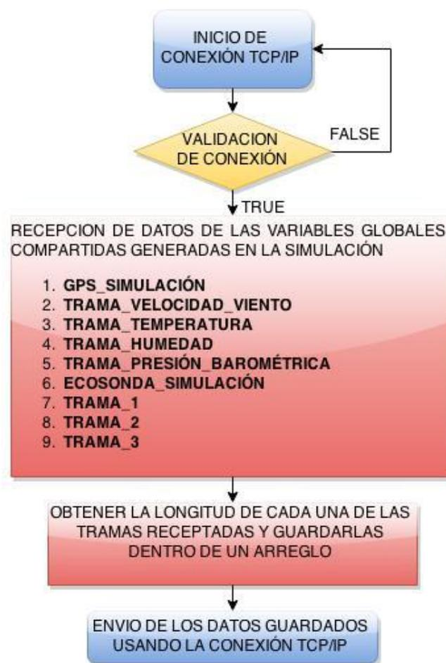
**Figura 4. 25 DIAGRAMA DE FLUJO – CONECTIVIDAD TCP/IP PARA SIMULADORES**
