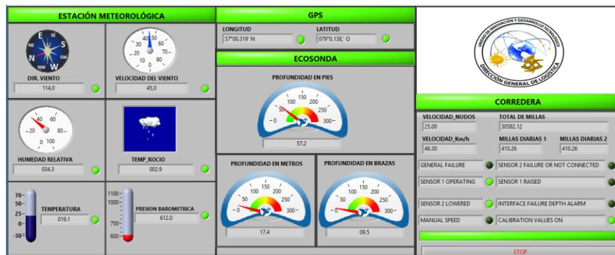
Figura 5. 15 RECEPCIÓN DE DATOS SIMULADOS
