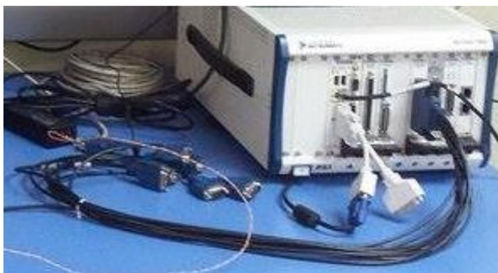
**Figura 5. 4 CABLES NI PXI-8431/8 (RS485/RS422) - PRUEBAS REALES**
