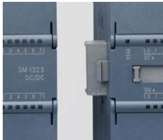
Figura 2.1: Borne de señal entre modulo y CPU [2]
