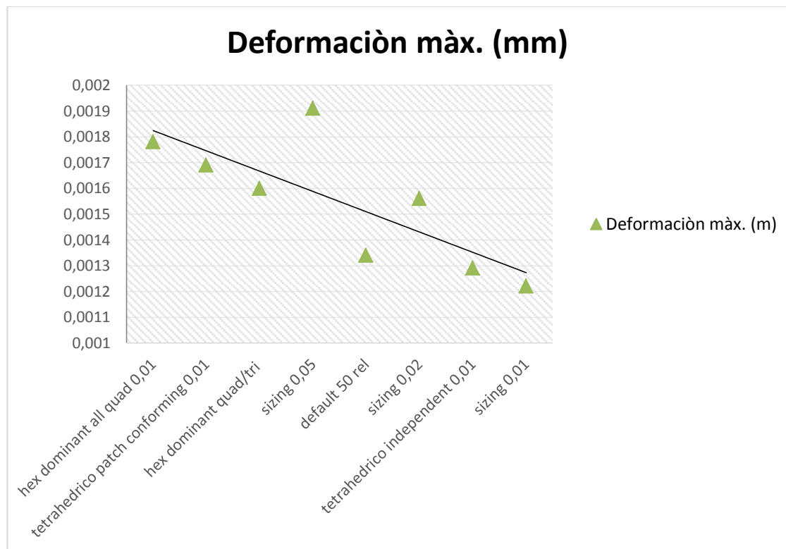
FIGURA 4.7. RESULTADOS DE LAS SIMULACIONES DE LAS DEFORMACIONES MÁXIMAS EN EL OBTURADOR
