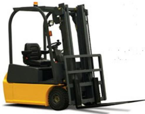
**Figura 7 Montacargas clase 1**
