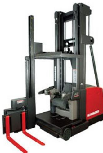
**Figura 8 Montacargas clase 2**
