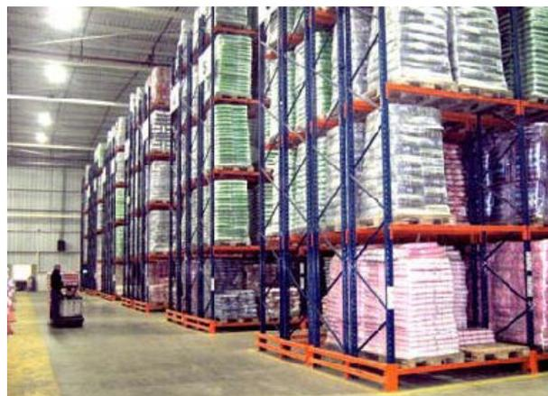
**Figura 6 Rack de doble profundidad**
