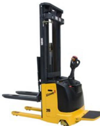
**Figura 9 Montacargas clase 3**
