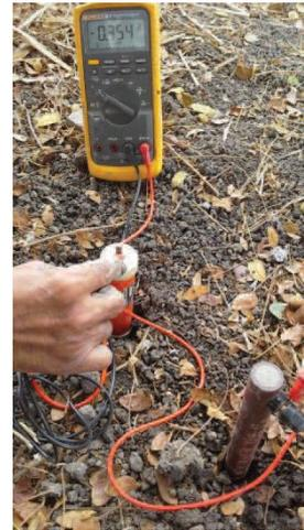
**Foto 8.** Medición de pH con el electrodo de Antimonio y Cobre-Sulfato de Cobre (en mV).
