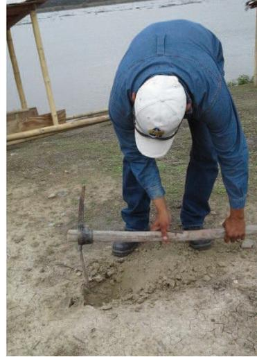
**Foto 16.** Se cava una profundidad de 15cm para recoger la muestra de los suelos.
