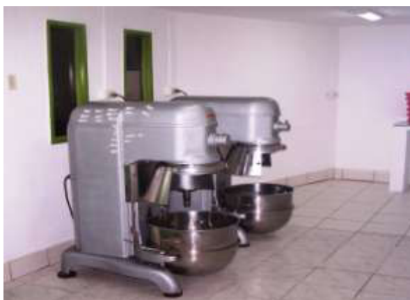
FIGURA 4.1 MEZCLADORES INDUSTRIALES DE PALETAS
